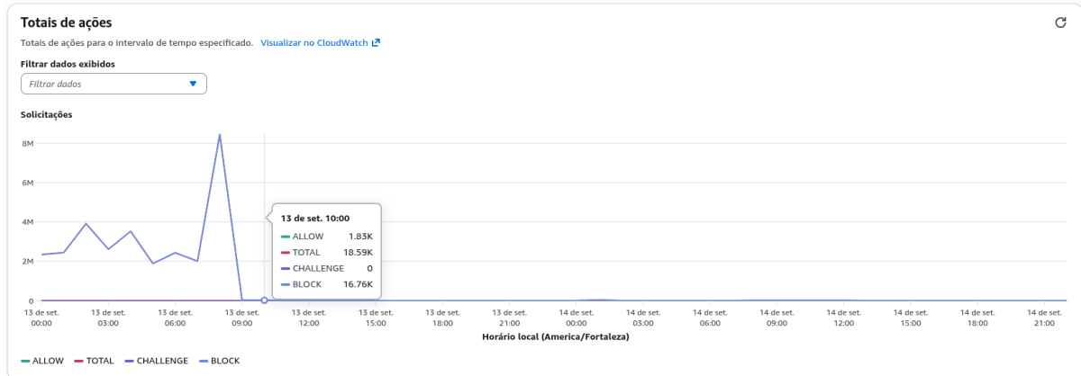
Figura 06 – Evolução do tráfego e das requisições bloqueadas até 13/09/2026 WAF.
